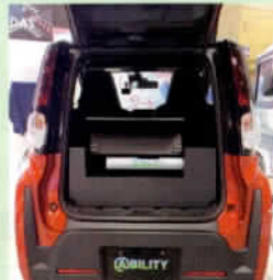
ABILITY 株式会社 水素モジュールを搭載した水素自動車 (FCV)
