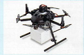
ACSL社製第一種型式認証取得機体 (レベル4(有人地帯での目視外飛行)に 対応したドローン) (株式会社ミラテックドローン展示)
