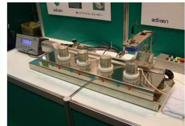
<容器頭部自動漏れ検査装置>
